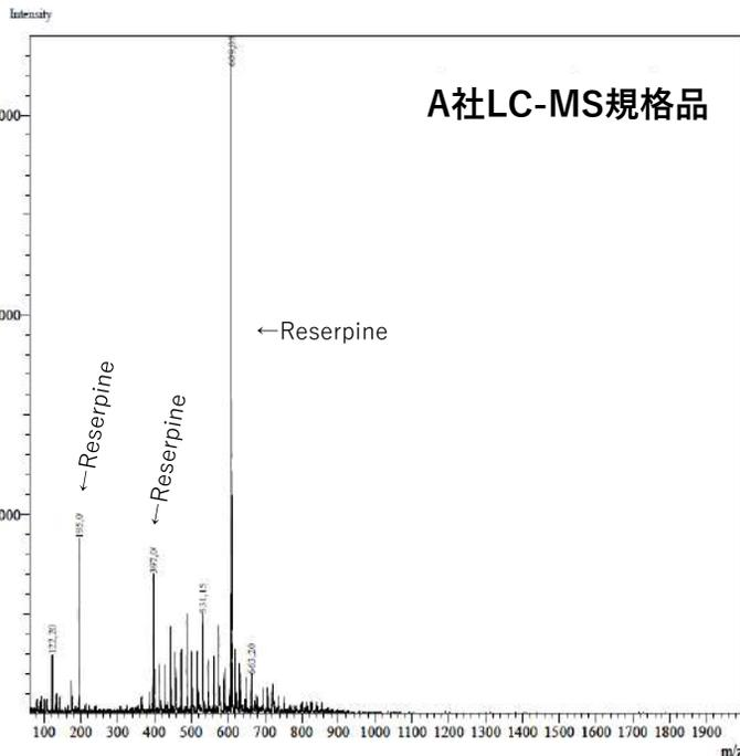
5ppb相当のReserpineを各社LC-MSグレードのアセトニトリルに添加し、測定した電子スプレーイオン化質量スペクトル。
